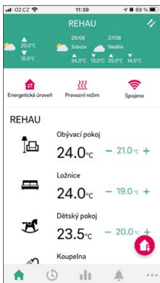
Obr. 160 Aplikace NEA SMART 2.0 Celkový přehled místností se zobrazením počasí a provozního režimu
