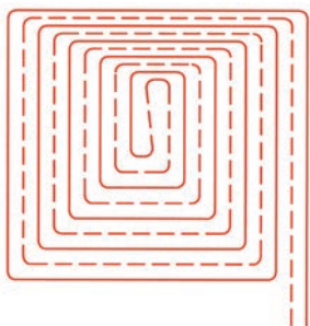
1. Pokládka formou spirály s integrovanou zhuštěnou okrajovou zónou
